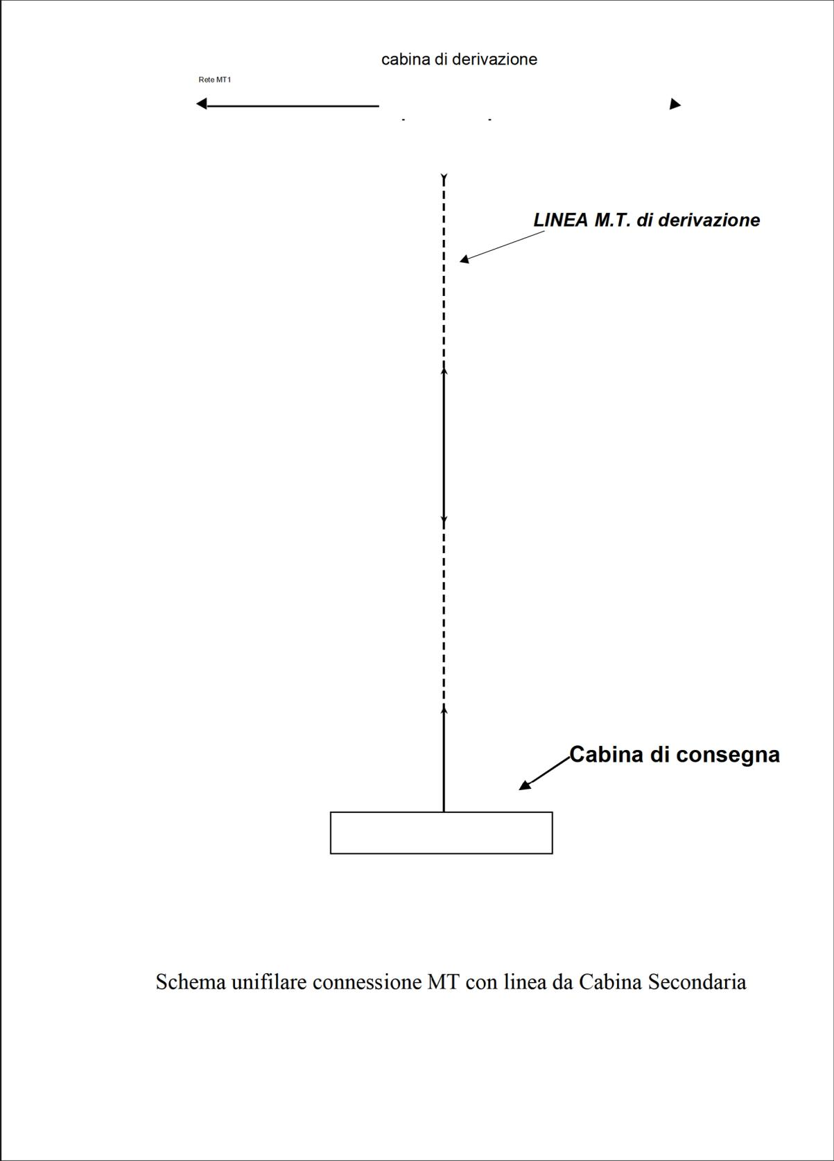
Schema unifilare connessione MT con linea da Cabina Secondaria
